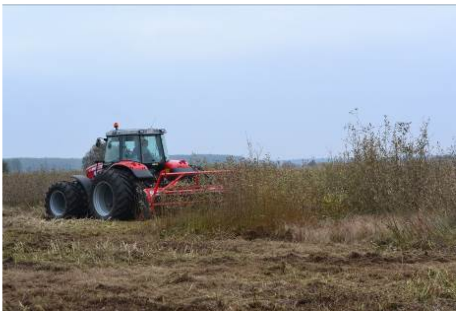
Рисунок 14 - Удаление кустарников на болоте Споровское с использованием трактора MF на сдвоенных колесах, оборудованного мульчером Seppi Midiforst
